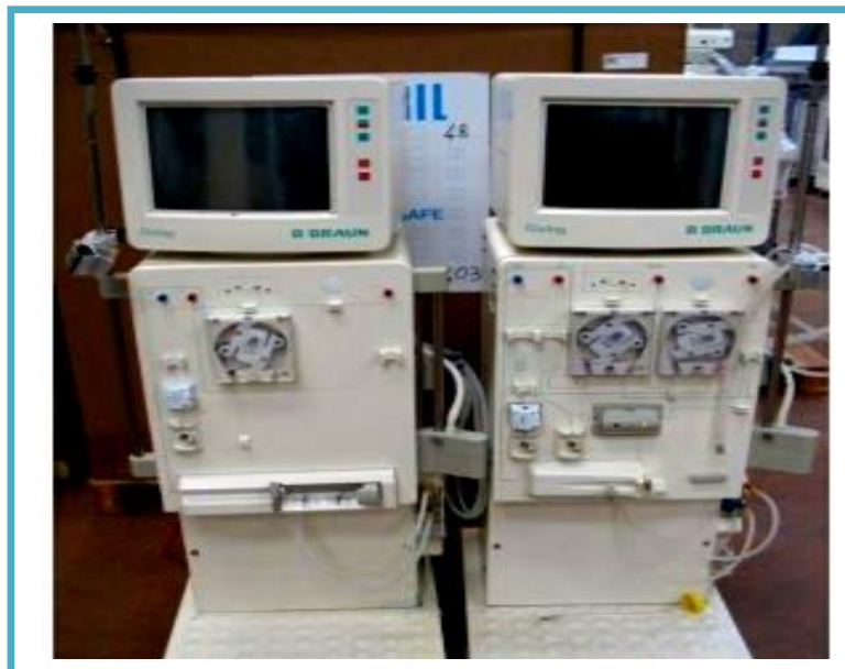
Figure 17 : Moniteur – générateur d'hémodialyse (Canaud, 2009).
